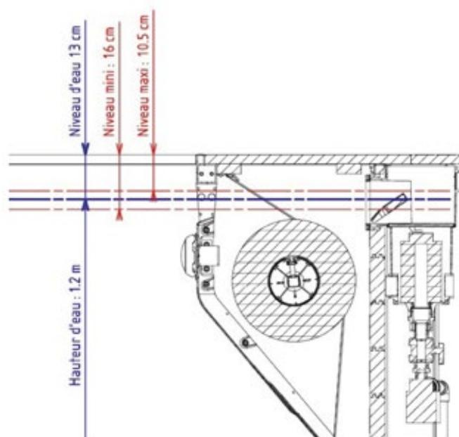
Figure 48 – Niveau d'eau dans le bassin
