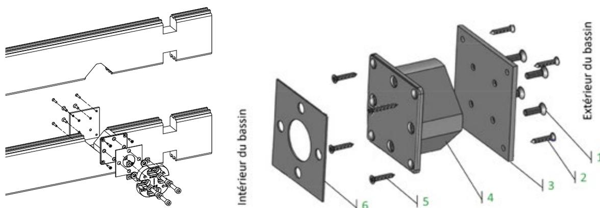
Figure 27 – Montage du support de palier
