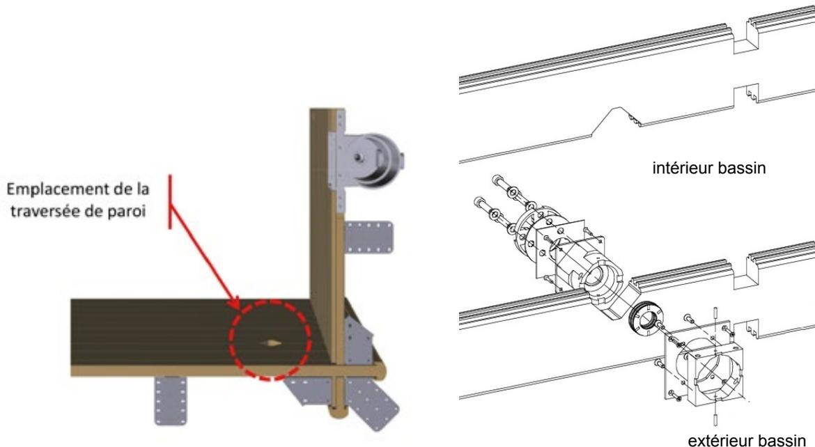
Figure 25 – Emplacement de la traversée de paroi
