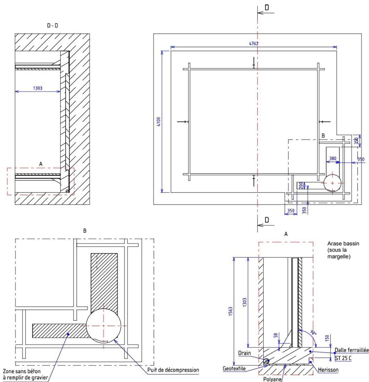
Figure 5 – Caractéristiques de la dalle de béton
