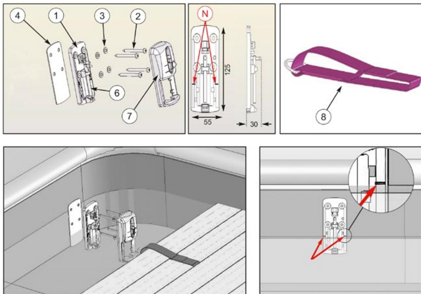
Figure 46 – Pose des accroches de tablier
