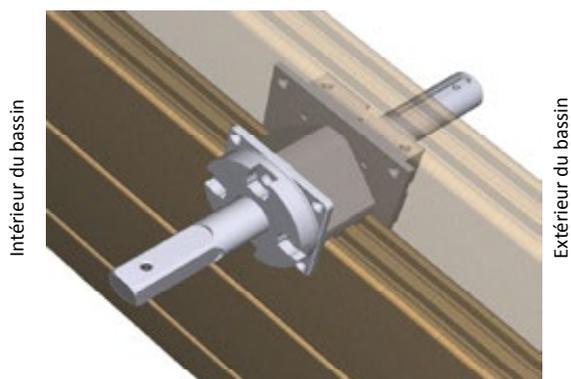
Figure 38 – Montage de l'arbre de couverture automatique
