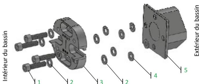
Figure 36 – Montage de la bride porte-palier
