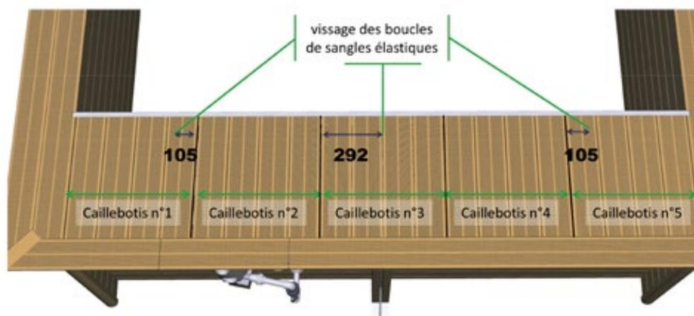
Figure 52 – Fixation des sangles élastiques sous les caillebotis
