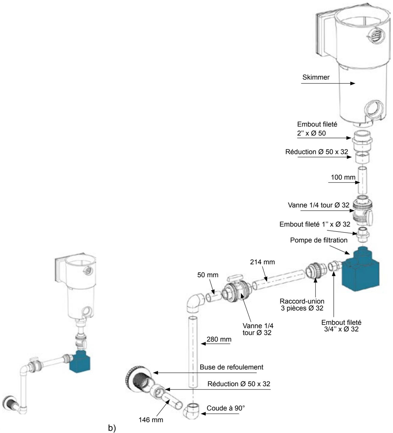
Figure 24 – a et b Tuyauterie pour la filtration
