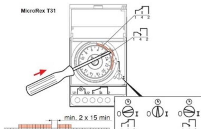
Figure 58 – Programmation automatique de la filtration
