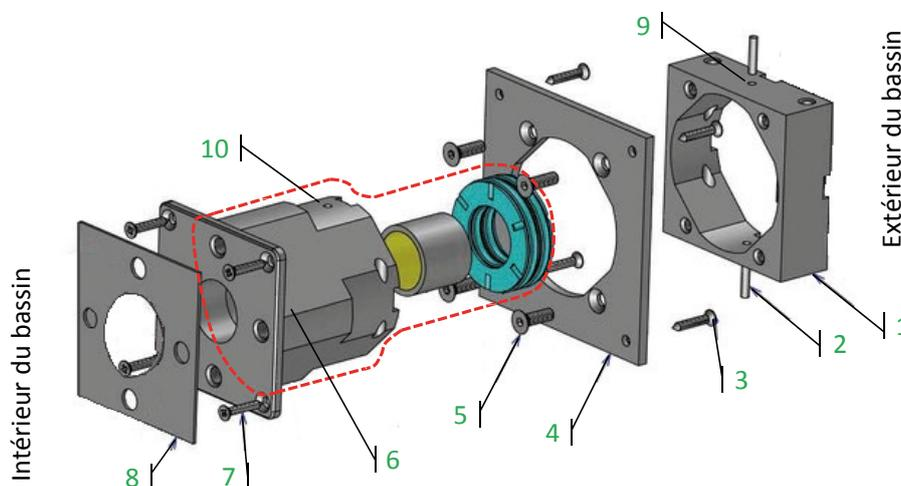
Figure 26 – Montage de la traversée de paroi
